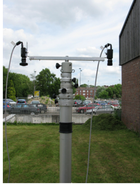
FIGURE 2 – Caméras montées sur un banc stéréo
