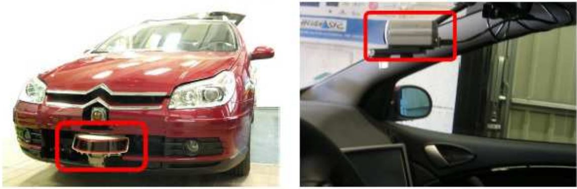
Fig. 6. Véhicule CARMEN du laboratoire Heudiasyc : configuration de la caméra et du Lidar
