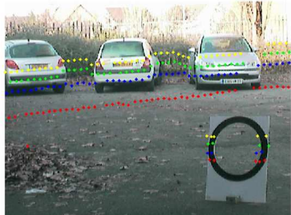
Fig. 7. Gauche : méthode de calibrage proposée par Rodriguez et al. [46]. La transformation à estimer est représentée par [\Phi, \Delta] . Droite : reprojction des impacts Lidar après calibrage.
