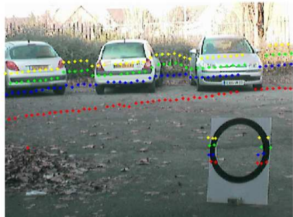
Fig. 7. Gauche : méthode de calibrage proposée par Rodriguez et al. [46]. La transformation à estimer est représentée par [\Phi, \Delta] . Droite : reprojexion des impacts Lidar après calibrage.
