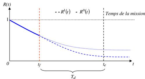
**Figure 4.** Fiabilité avant et après apparition du défaut
