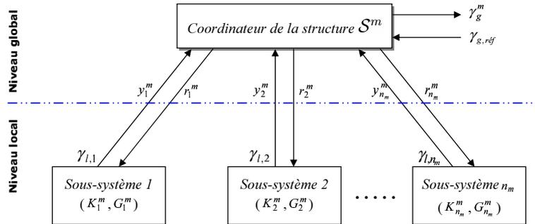
**Figure 6.** L'architecture du système sous une structure  $\mathcal{S}^m$
