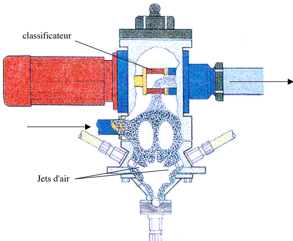
*Figure 12. Schéma d'un broyeur à jets d'air opposés avec classificateur intégré (avec l'aimable autorisation de la société Hosokawa Alpine)*
