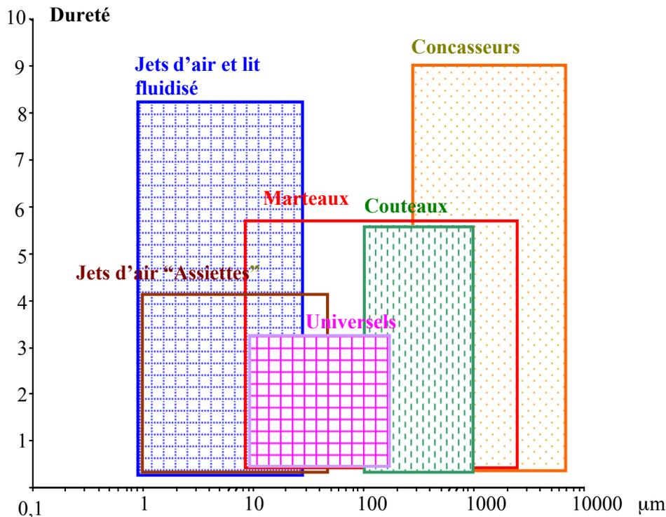
Figure 7. Les différents types de broyeur en fonction de la dureté du matériau et de la taille du produit à obtenir.
