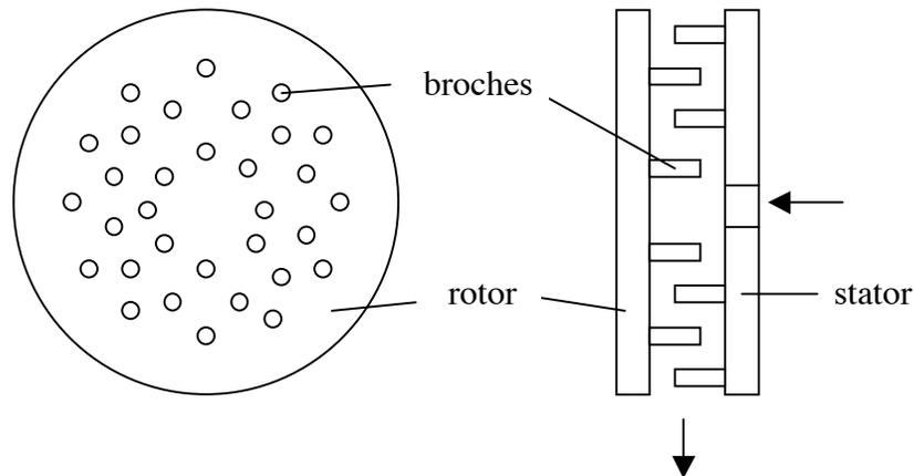
Figure 10. Couple rotor-stator d'un broyeur universel équipé de broches
