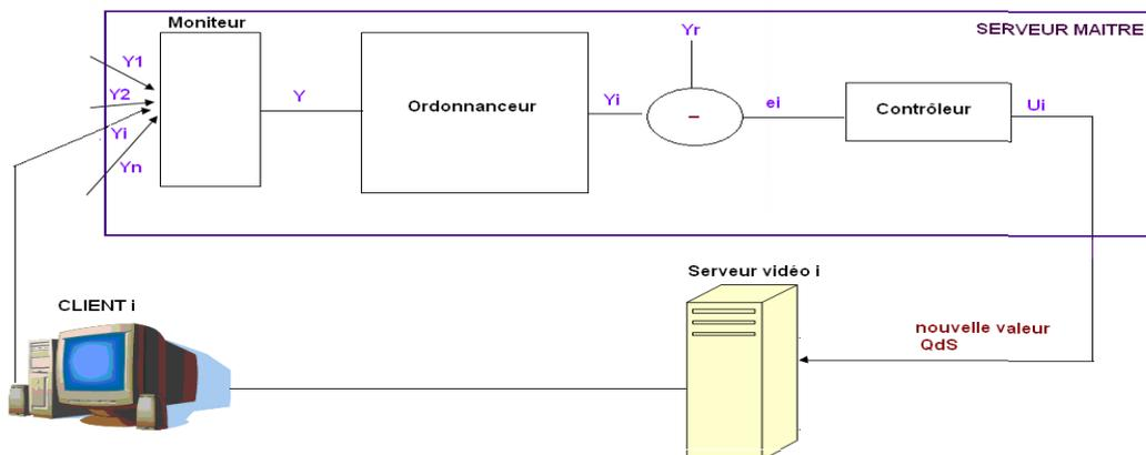
FIG. 2- Architecture de contrôle par rétroaction du serveur maître.
