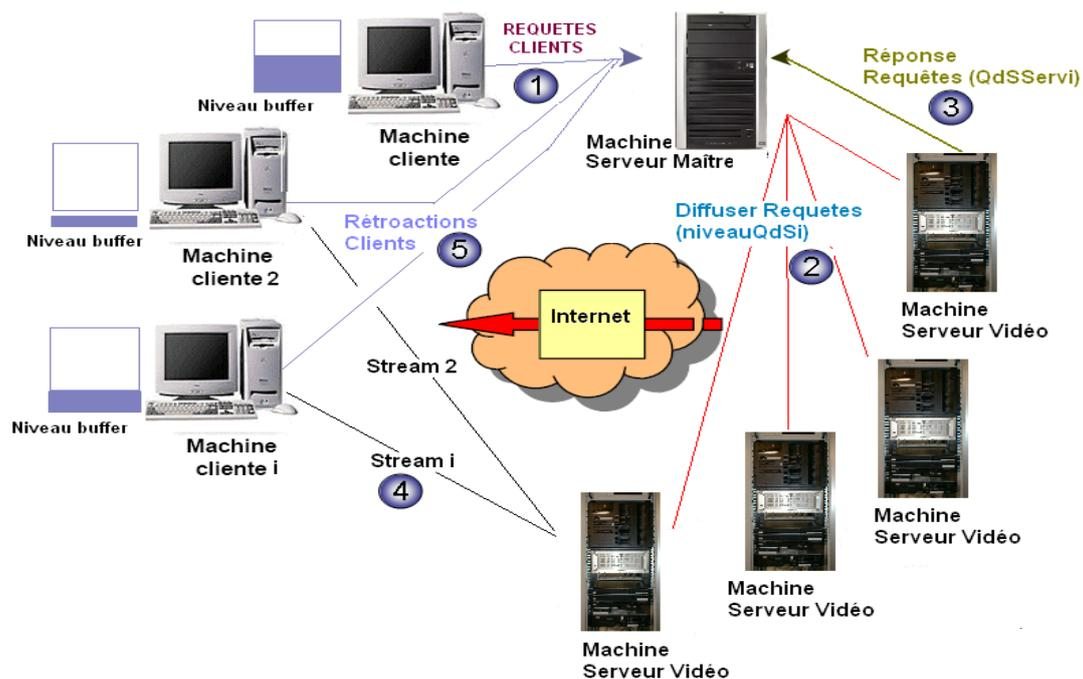
FIG. 1- Scénario de fonctionnement de l'architecture FCS-MS.
