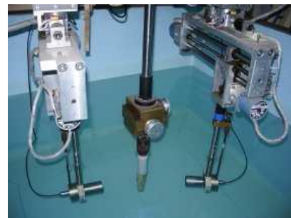
Figure 3 : Vue d'un sondage ultrasonore d'un fémur
