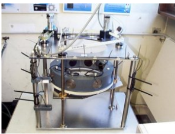
Figure 4 : Antenne circulaire multivoie pour l'imagerie tomographique en diffraction
