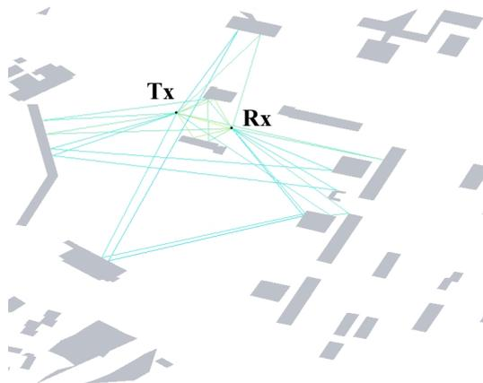
Figure 10 : trajets suivis par les ondes entre l'émetteur (Tx) et le récepteur (Rx)
