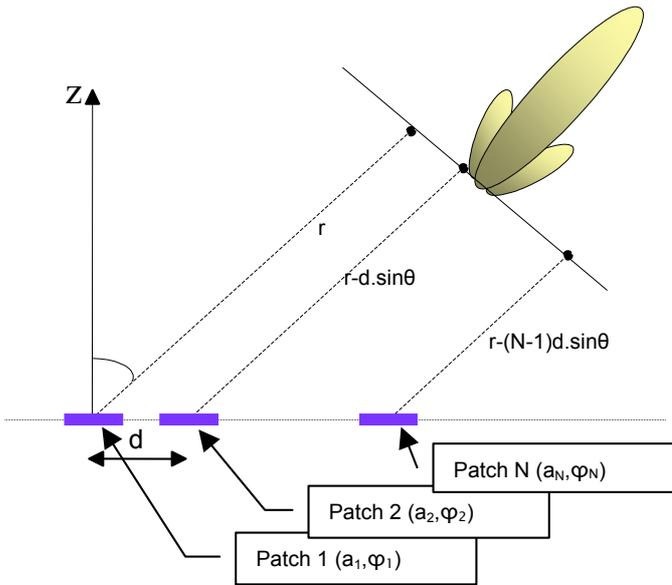
Figure 1 : Réseau linéaire d'antennes « patch »
