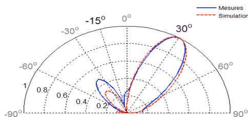
Figure 7 : Diagrammes de rayonnement théorique et mesuré
