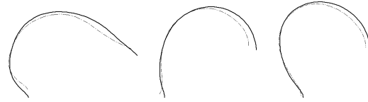
Figure 4: Les trois plus mauvaises reconstructions (resp. 2.2 pixels, 1.9 pixels, 1.8 pixels) avec six composantes linéaires pour la stratégie 2 et l'approche 2 (en trait gras : le contour reconstruit et en pointillés : le contour original).
