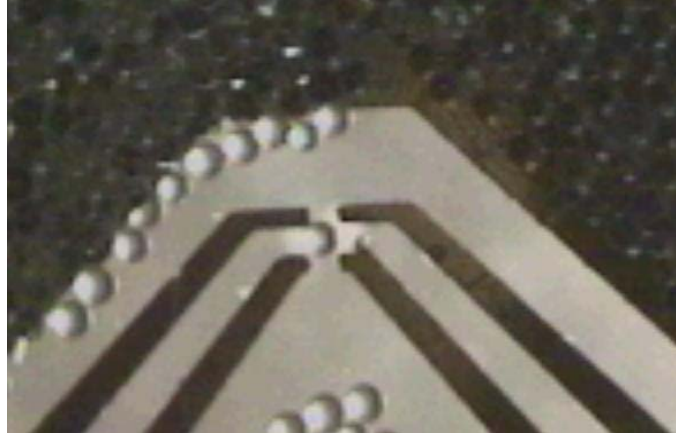
Figure 4 : Bille de polystyrène de 80 micromètres en lévitation au dessus des quatre électrodes.
