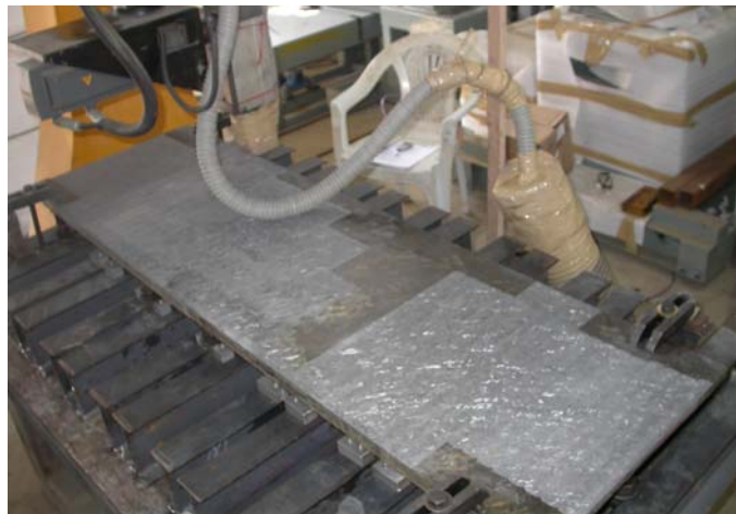
Fig. 3. Moule HexTOOL™ en cours d'usinage (Projet EUDET, source : CES – Courtesy of LLR – IN2P3).
