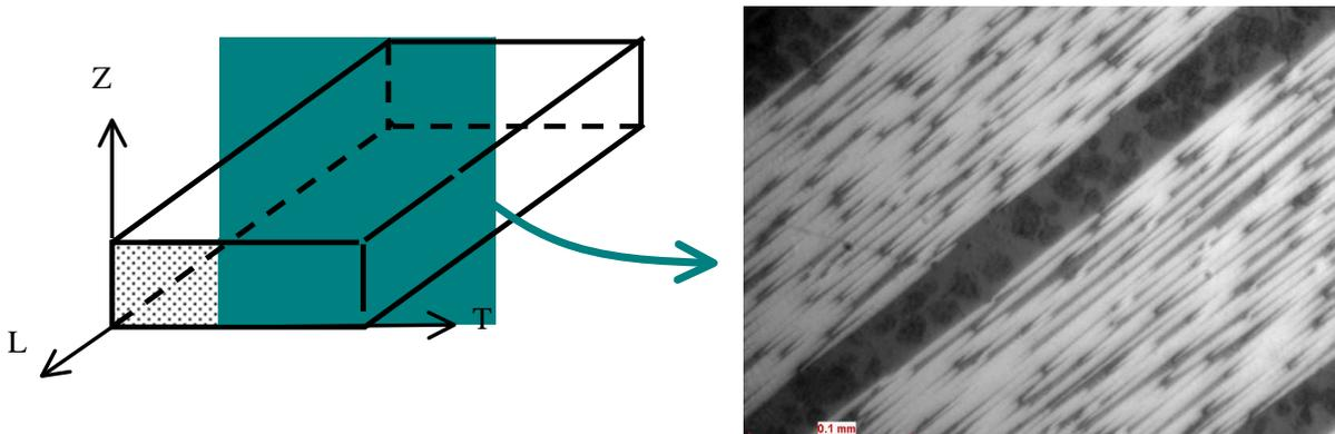
Fig. 6. Micrographie d'un stratifié  $[0_8]$  en coupe
