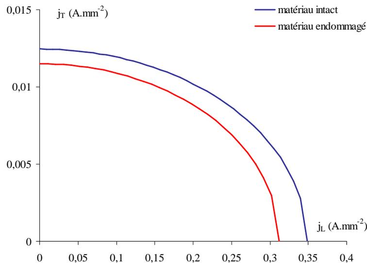
Fig. 11. Densités de courant admissibles par l'UD IMS/E21
