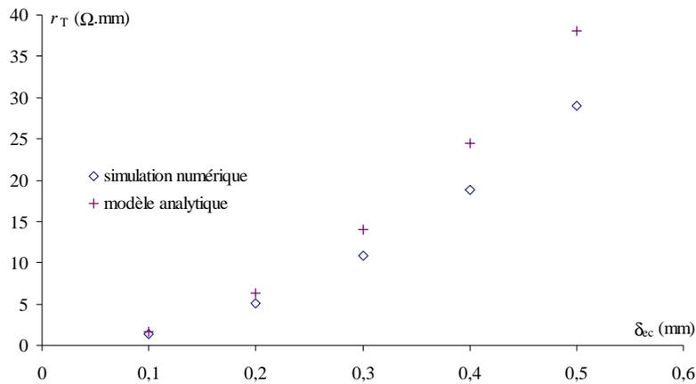
Fig. 9. Evolution de la résistivité transverse avec  $\delta_{ec}$
