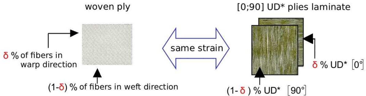
Fig. 3 : Modèle généralisée.
