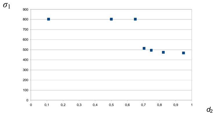
Fig. 8. Résistance sens fibre en fonction de l'endommagement transverse.
