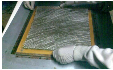
Fig. 2. Positionnement du pli de fibre mat
