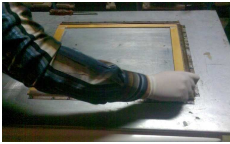
Fig. 1. Moule en bois sur une plaque métallique
