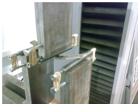
Fig. 7 : Machine d'essais de flexion trois points
