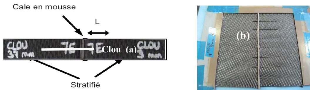
Fig.8. Eprouvettes d'arrachement de clou dans stratifié : principe (a) ; fabrication (b).
