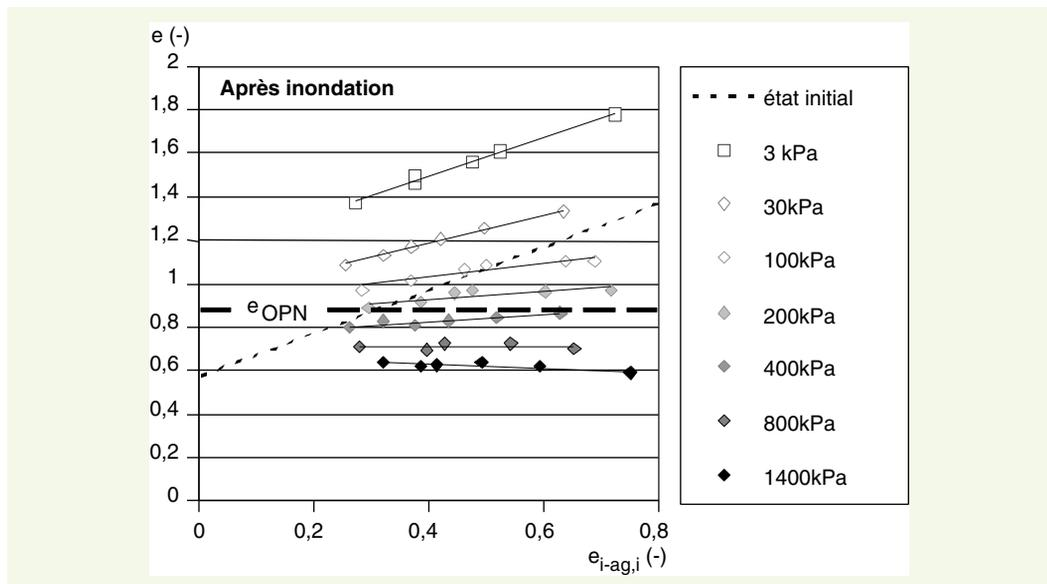
au-delà de 400 kPa (20 mètres de hauteur de remblai), l'inondation génère systématiquement un tassement. Entre 30 et 400 kPa, le comportement des échantillons dépend de leur indice des vides inter-agrégats initial : les échantillons les plus compactés (faible indice des vides inter-agrégats initial) gonflent alors que les échantillons les moins compactés tassent.
