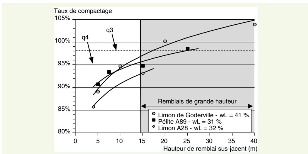
inondation de la base d'un remblai de 20-25 mètres de hauteur. On retrouve ici la notion d'adéquation entre taux de compactage et hauteur de remblai [16].
