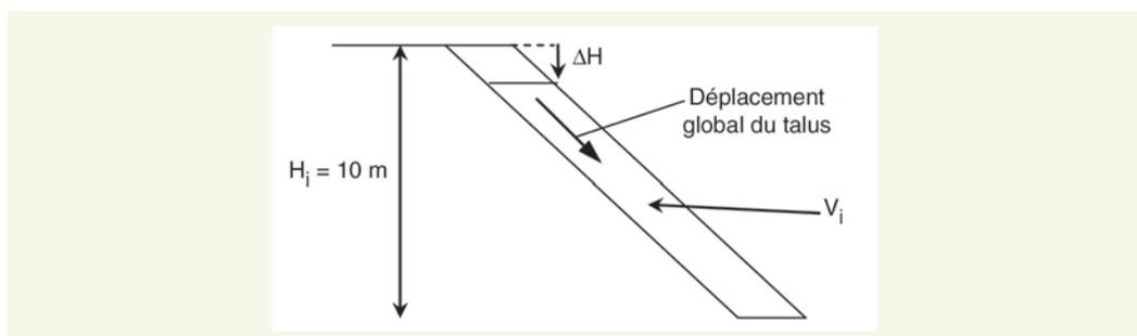
Si l'on applique l'équation (8) au cas d'un remblai de 10 mètres de hauteur ( $H_i$ ), il est possible de déterminer le tassement total en fonction du taux de compactage (équation (9)) appliqué (figure 21).
