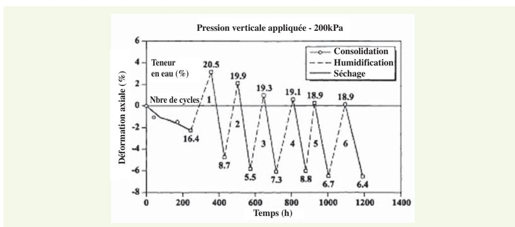
Pour étudier ce phénomène, un cycle d'humidification-séchage a été appliqué à des échantillons de l'argile A34 compactés à une même teneur en eau (égale à 9 %, c'est-à-dire dans un état très sec au sens du GTR) mais à différentes masses volumiques sèches. Concrètement, les échantillons ont subi un essai de gonflement libre en œdomètre, puis ils ont été séchés lentement en dessiccateur de manière à limiter la fissuration.
