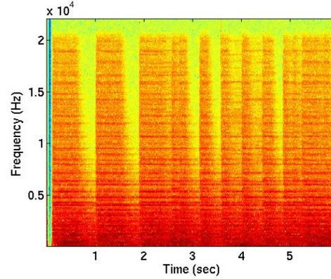
FIGURE 2 – Coefficients MDCT d'un signal d'orgue
