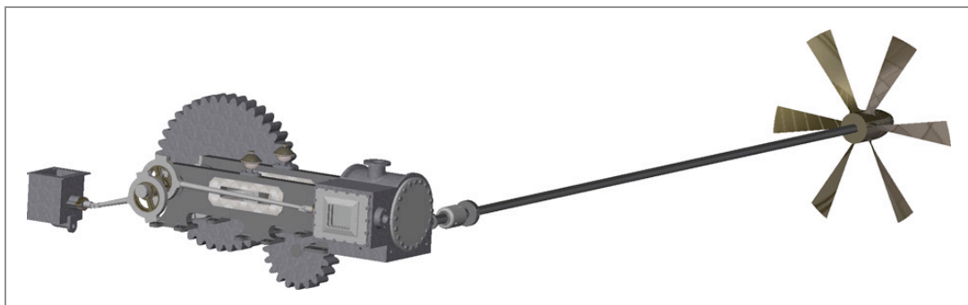
Canot à vapeur de 1860, Maquette CAO de la transmission
