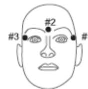
Fig. 1 Montaje de electrodos EOG (Extraído de BCI Competición 2008 - Graz data set B (6))
