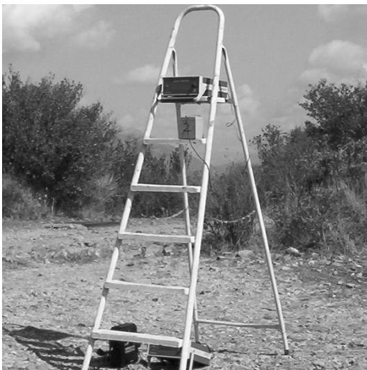
Figure 1. Dispositif permettant d'étudier l'influence du sol sur les taux d'ozone.
