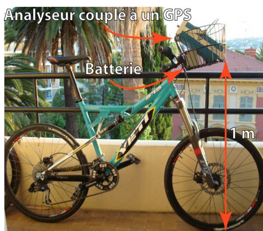
Figure 1 Mode de transport et dispositif de mesure
