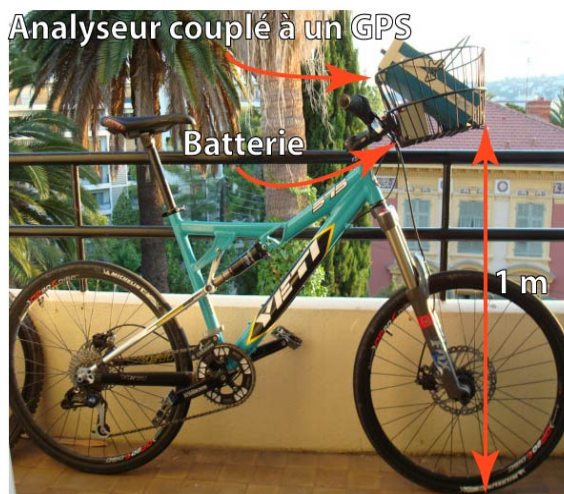
Figure 1 Mode de transport et dispositif de mesure
