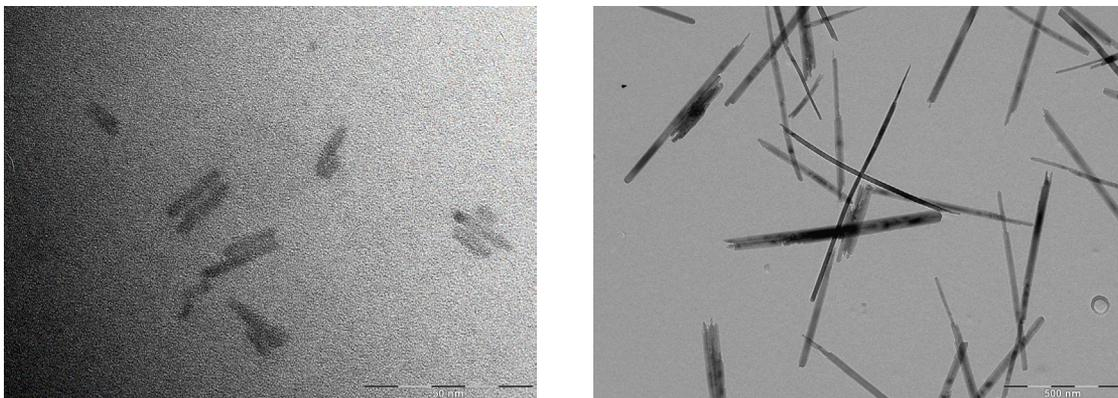
Figure: Clichés MET de nano-bâtonnets de goethite de tailles très différentes selon les synthèses (les barres d'échelle mesurent 50 nm à gauche et 500 nm à droite).
