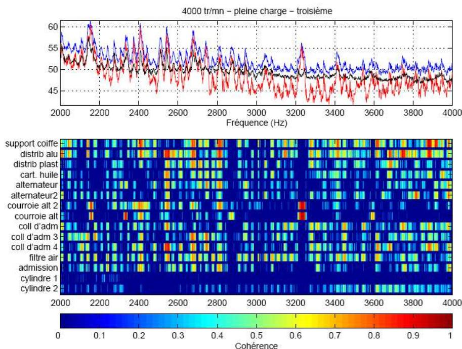
FIG. 4– signature du moteur en fonctionnement, 4000tr/mn pleine charge, 3<sup>ème</sup> dans la bande 2kHz – 4kHz
