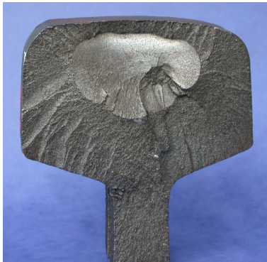
Figure 1 : Illustration d'un défaut interne.
