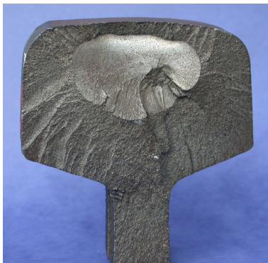
Figure 1 : Illustration d'un défaut interne.
