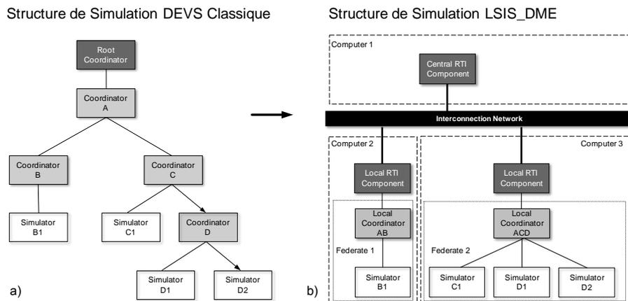
**Figure 6.** Structure de simulation distribuée G-DEVS / HLA
