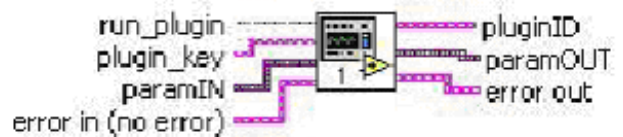
Fig. 2. Modèle de Plug-in (template): avec gestion d'erreur, d'identifiant, et transmission de paramètres (data)
