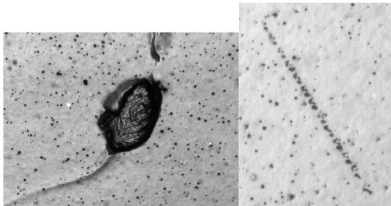
Figure 9 : Film localement brûlé.      Figure 10 : Alignement de grains
