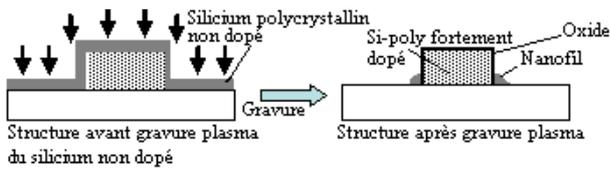
Figure 4 : vue en coupe des nanofils réalisés par la méthode des espaceurs MOS.
