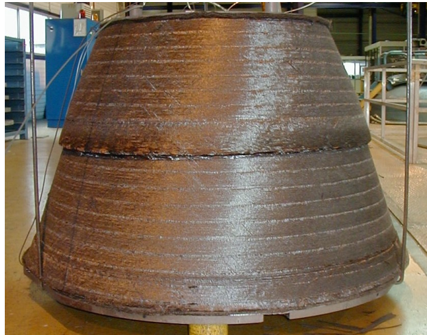
Fig. 5. Grand divergent C/C (stade densifié, non usiné).
