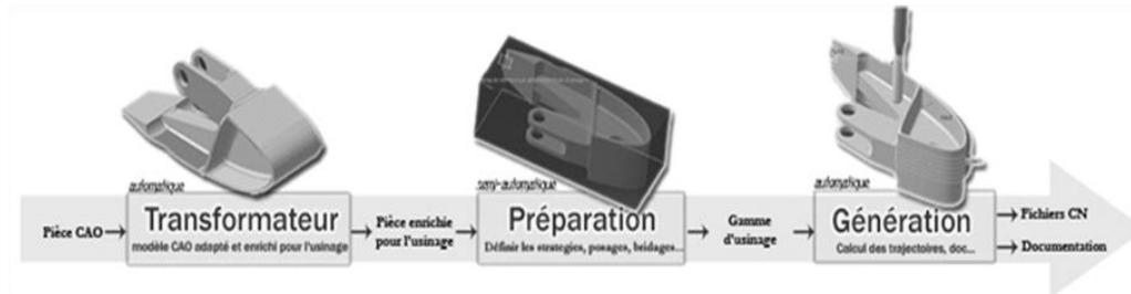
Figure 1. Architecture du logiciel d'aide
