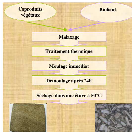
Fig. 3 : Procédé d'élaboration des composites agroliés
