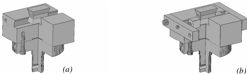
Figure 6 : Montage classique avec queue d'aronde 1D (a) et montage hyperstatique réglable avec queue d'aronde 2D (b)
