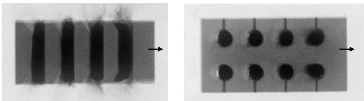
Fig. 13. Radiographies-éclair du projectile à la bouche du lanceur (tir n°3)
