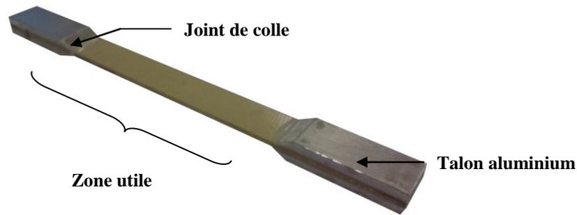
Fig. 5. Eprouvette de traction verre S2/PEEK
