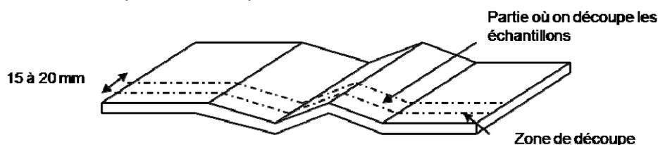
Fig. 9 : Zone de découpe des pièces après thermoformage
