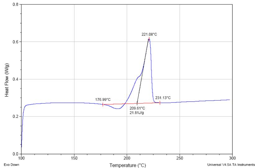
Fig. 1 Courbe de DSC pour le polyamide 6
