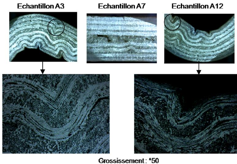
Fig. 11 : Micrographie obtenue pour l'échantillon A
