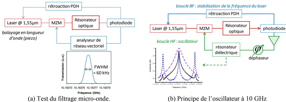
Fig. 2 : Dispositifs d'utilisation du résonateur optique.
