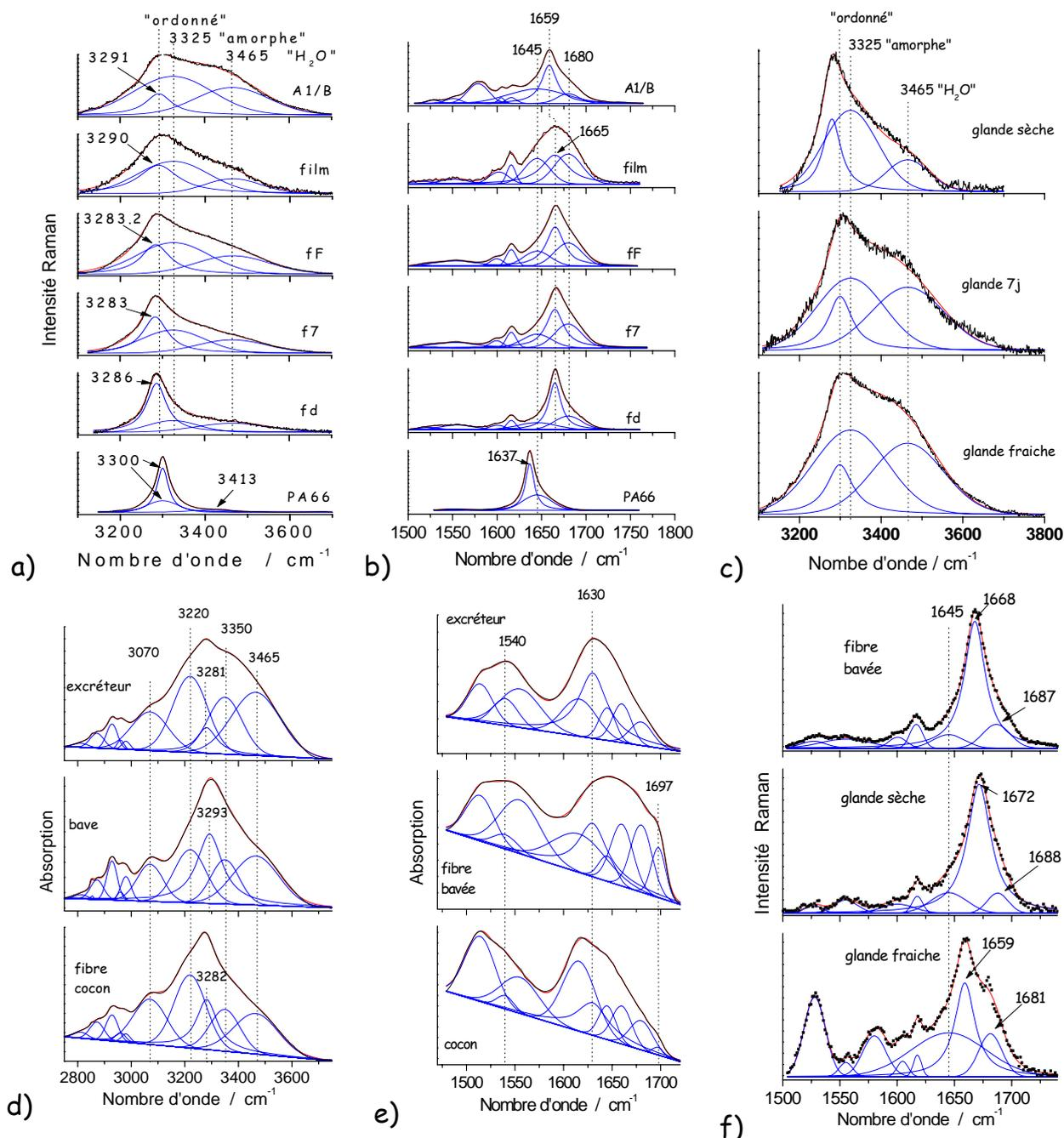
Fig. 4. Comparaison des signatures des modes d'élongation Amide I (b, f, Raman, e, IR), II (e, IR) et des modes  $\nu$ N-H et  $\nu$ O-H en diffusion Raman (a,c) et absorption IR (d) pour la soie du précurseur de fibre, une fibre fraîche, une fibre décreusée ainsi que pour la zone centrale de la glande, fraîche (juste après dissection) et séchée.
