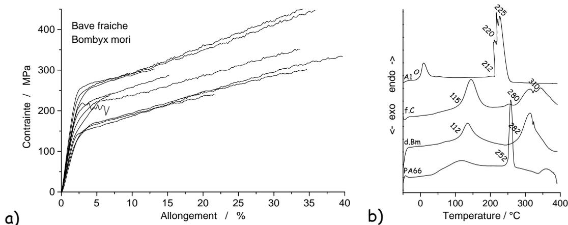
Fig. 2. a) exemples de courbes contrainte-allongement obtenues pour des baves fraîches extraites manuellement ; b) courbes DSC de précurseur(A1), de fibres de cocon frais (f.c.), de cocon décreusé (d. Bm) et de polyamide 66 (PA 66).
