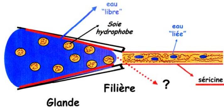
Fig. 5. Représentation schématique de la formation du filament de soie à partir des données de spectroscopie et de calorimétrie.
