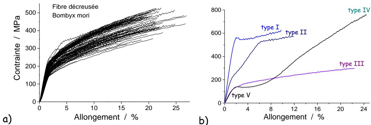
Fig. 1. a) courbes de traction uniaxiale Conainte/Allongement de fibres de *Bombyx mori*, décreusées ou non ; b) courbes type ; le type IV a été obtenu pour une fibre de *Nephila madagascarensis*. Les types sont définis selon l'allure, non par le niveau de la contrainte de rupture (d'après [7]).
