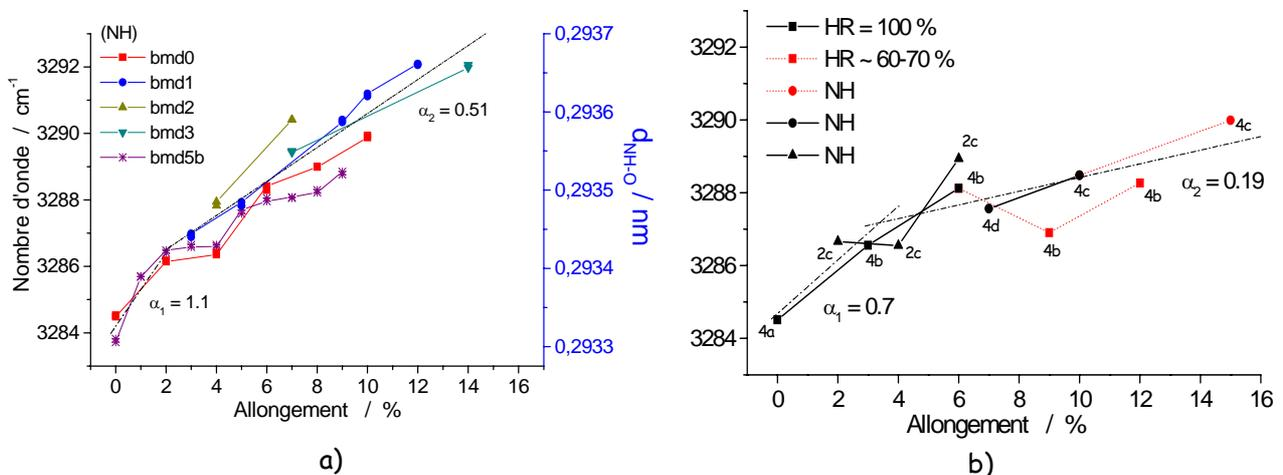
Fig. 6. a) évolution du nombre d'onde du mode d'élongation  $\nu N-H$  pour 5 fibres (séchées, humidité relative ~60%) en fonction de l'allongement appliqué ; b) évolution pour 2 fibres saturées d'eau et mesurées partiellement immergées. Les mesures sont faites en régime quasi statique (pas de = 2%:2h).
