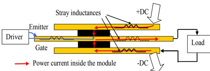
Figure 11 : Stray inductances on the press pack module
