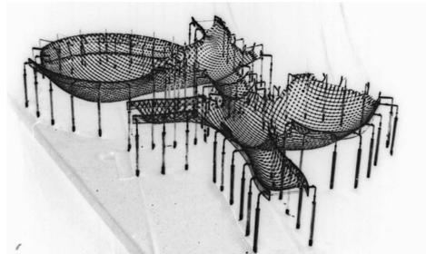
Fig. 2. Maquette inversée du grid shell de Mannheim.
