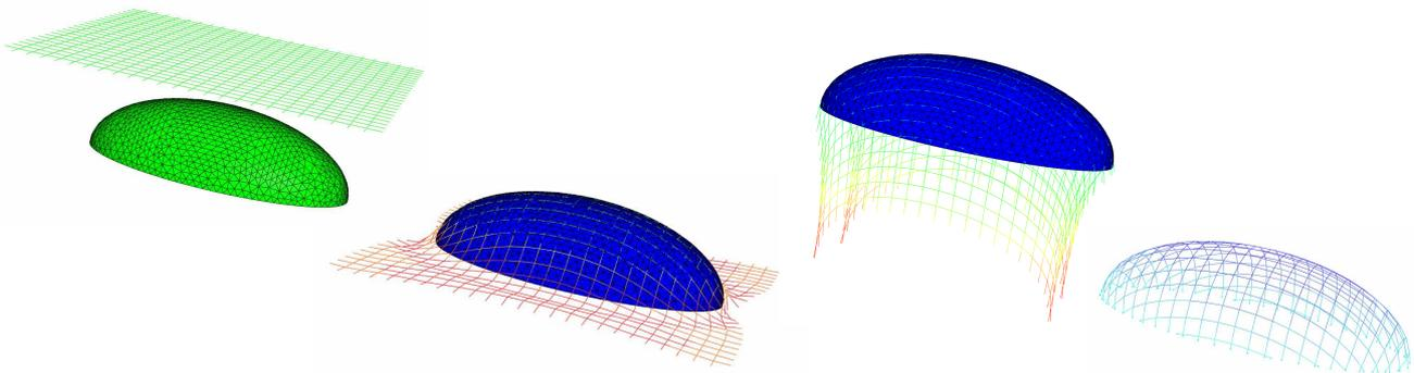
Fig.8. Etapes de maillage d'une ellipse 3D en éléments finis.
