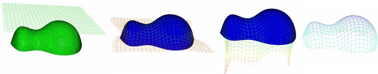
Fig.9. Etapes de maillage d'une surface à double bosse en éléments finis.
