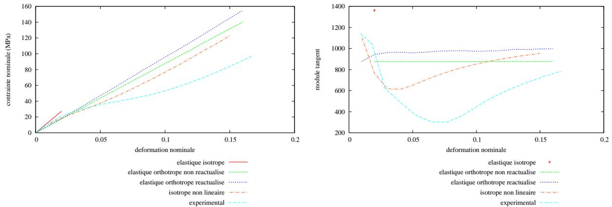
FIG. 4 – Comportement macroscopique du matériau hétérogène (à gauche) dans la direction chaîne et évolution du module tangent (à droite) en fonction de la déformation moyenne  $E_{11}$  imposée.
