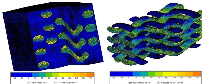
FIG. 5 – Distribution de la contrainte  $\sigma_{11}$  dans la cellule périodique (à gauche) et le tissu (à droite) après application d’une déformation longitudinale de 0,02 et un comportement élastique isotrope pour les constituants.
