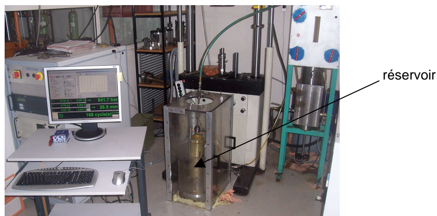
Fig. 8 : Essai de fatigue sur un réservoir de type III à 1050 bar
