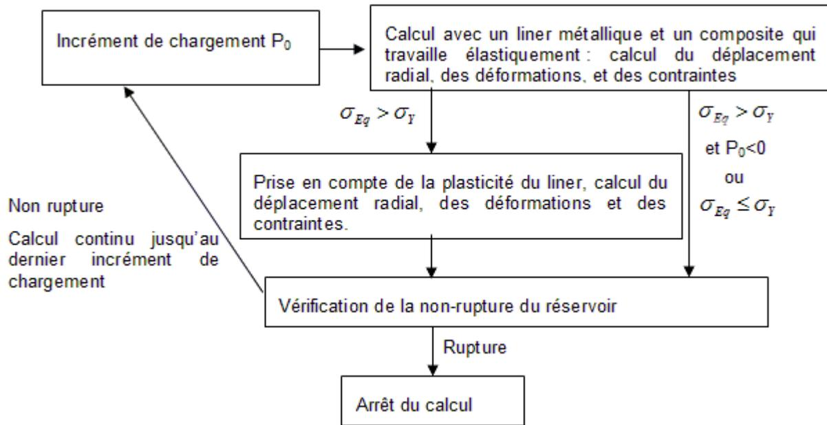
Fig. 6: Principe du calcul analytique
