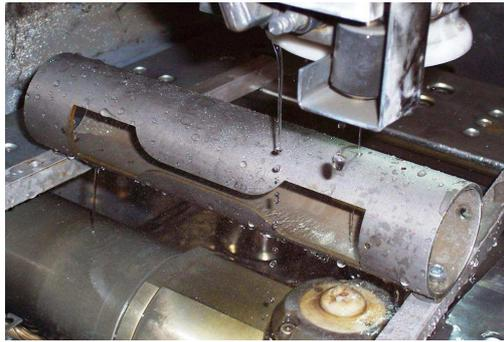
Fig. 3: Usinage des éprouvettes par électroérosion à fil
