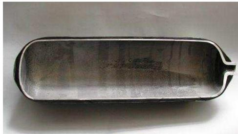
Fig. 1: Coupe d'un réservoir de type III
