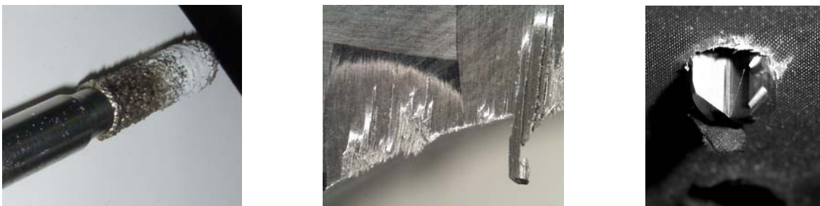
Fig. 1. Meule encrassée (gauche), délaminage et plis non coupés francs en fraisage et perçage (droite).
