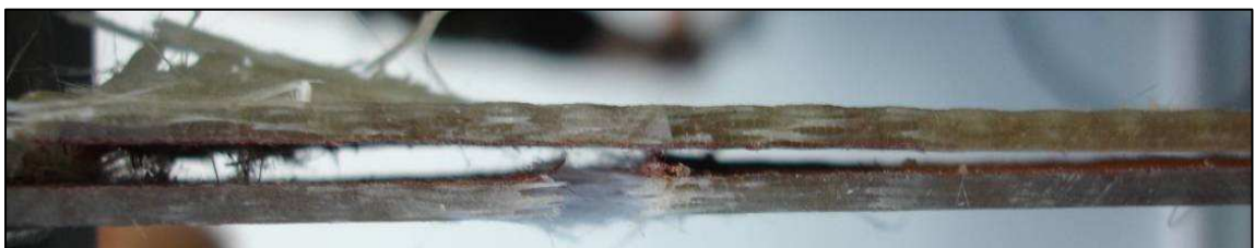
Fig. 6. Faciès de rupture d'une éprouvette de traction avec écran au milieu.
