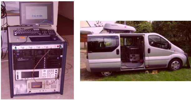
Figure 5. Le sondeur et le véhicule équipé du sondeur.
