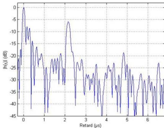
Figure 3. Exemple de réponse impulsionnelle mesurée sur Paris.
