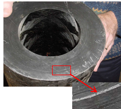
Fig. 2. Défauts dans un tube d'extraction pétrolière d'épaisseur 80 mm (collaboration avec IFREMER).
