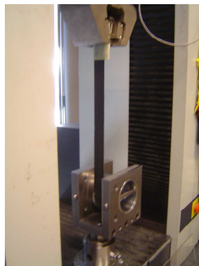
Fig. 9. De gauche à droite : schéma du dispositif d'essai, photo d'un essai, photo d'une éprouvette après rupture montrant le marquage de l'acier dans la zone de frottement
