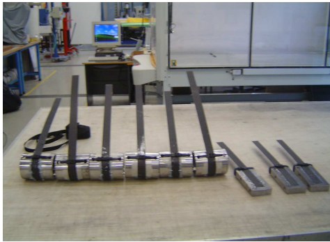
Fig. 8. Photo des joints collés réalisés avec empilements d'UD pré-imprégné avec une résine polymérisant à chaud à gauche, et tissu imprégné de résine polymérisant à froid à droite
