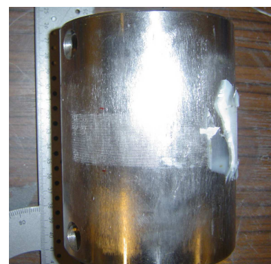
Fig. 9. De gauche à droite : schéma du dispositif d'essai, photo d'un essai, photo d'une éprouvette après rupture montrant le marquage de l'acier dans la zone de frottement
